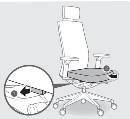
Потяните на себя скользящий рычаг регулировки глубины справа под сиденьем (1)
