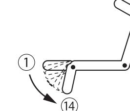
Отклоните подставку ног в максимально вертикальное положение. Затем нажмите вниз, чтобы поднять подставку ног, возвратив ее в оригинальное положение.
