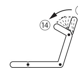
Отклоните подголовник в максимально вертикальное положение. Затем нажмите вниз, чтобы поднять его в оригинальное положение.
